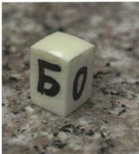
Характерный вид образца Б при истирании по сукну ДО истирания
